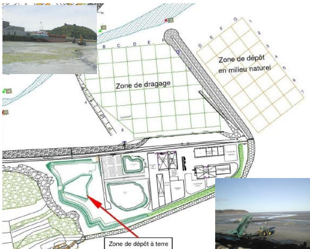
D'un point de vue opérationnel, les travaux sont opérés à marée basse à l'aide d'engins de chantier qui cheminent entre les zones d'extraction et de dépôt (1 pelle et 2 dumpers).
