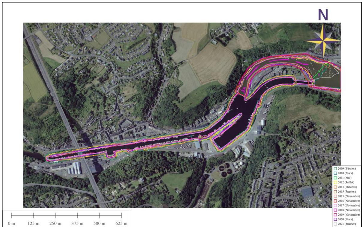
Figure 2-31 Emprises des levés bathymétriques mis à disposition par la CCI pour les analyses morpho-sédimentaires sur le secteur des bassins à flot et du port de plaisance.
