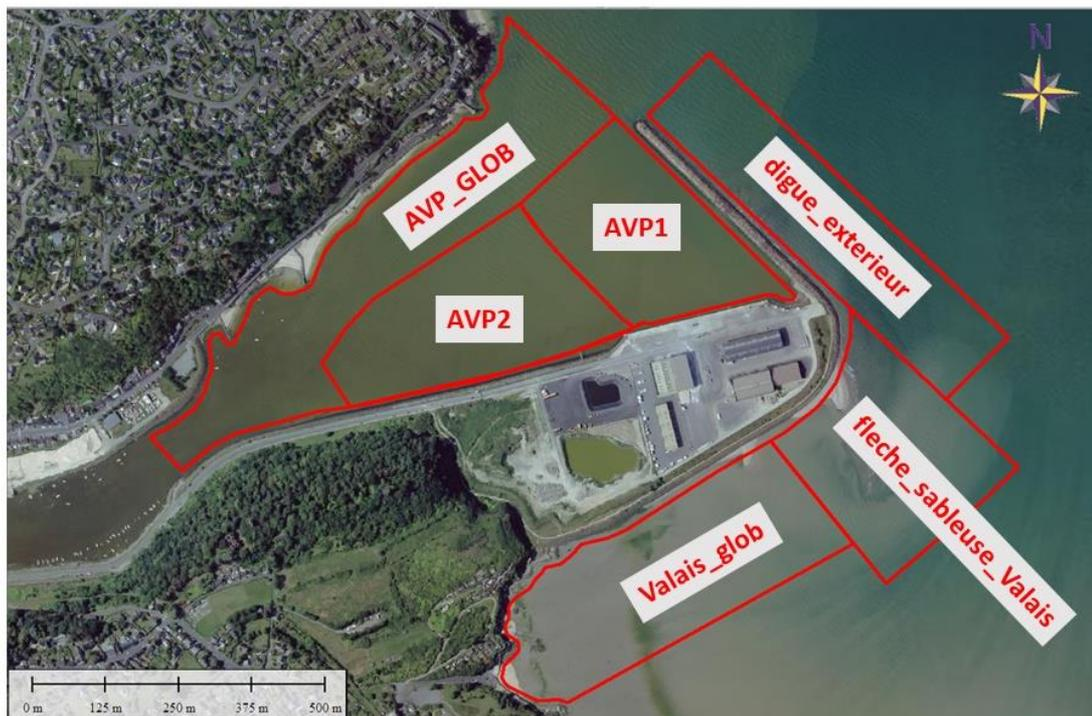
Figure 2-55. Contours définis pour les bilans sédimentaires - secteur de l'avant-port et zone extérieure.
