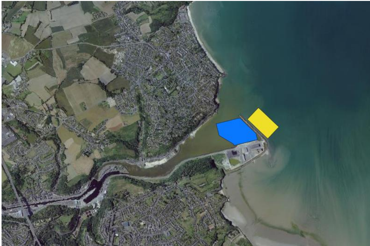
Figure 1-2. Port du Légué et localisation des zones de dragage dans l'avant-port (bleu) et de dépôt derrière la digue (jaune)- Ancien arrêté préfectoral.
