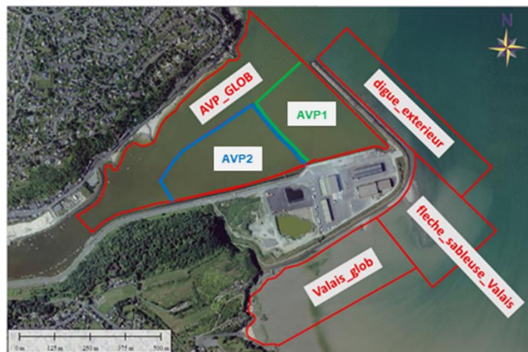
Figure 4-1 Zones considérées pour les bilans sédimentaires (identiques à celles définies dans les analyses morpho-sédimentaires de la phase 1).
